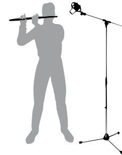
Abbildung 8: Aufnahme der Querflöte mit nur einem Mikrophon
