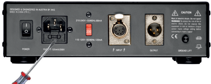
Figura 4: Abrir el compartimento de los fusibles
