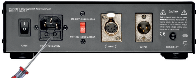
Abbildung 4: Öffnen des Sicherungsfachs
