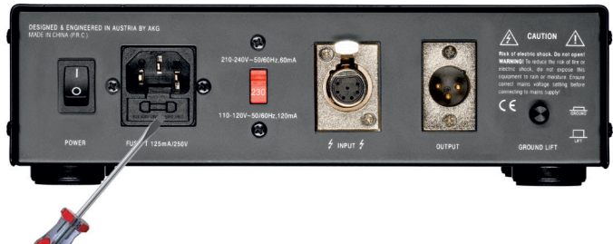
Figure 4: Ouverture du compartiment des fusibles
