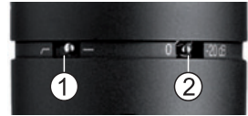
Figura 1: Interruptores de filtro de bajos y de preatenuación en la parte frontal del micrófono
